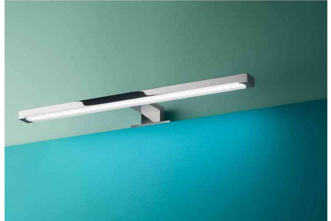
**Applique LED a proiezione diffusa realizzato in lega metallica con finitura cromo lucido ideale per l'illuminazione di specchiere da bagno. Diffusore in metacrilato opale ed alimentatore integrato per alimentazione diretta 100-240VAC. Grado di protezione contro gli spruzzi d'acqua IP44.**
