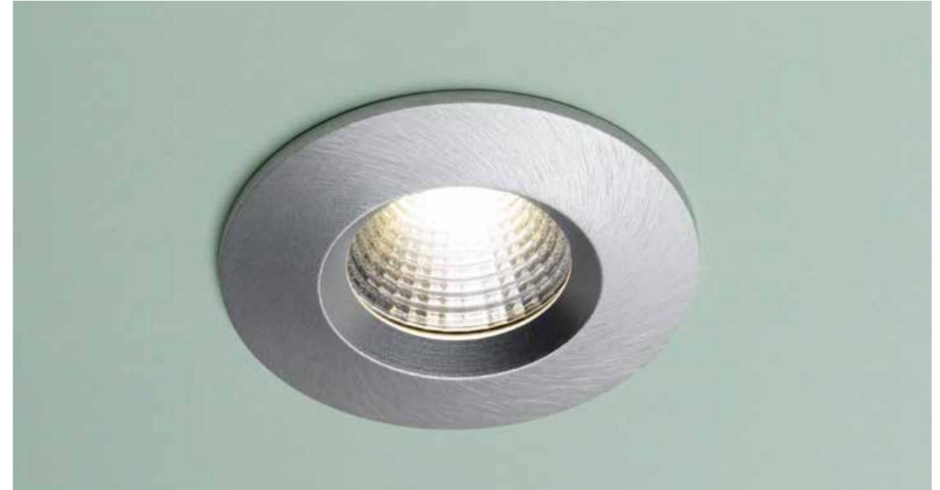
**BRUC è un faretto di forma circolare per montaggio ad incasso, realizzato in alluminio tornito con molle di fissaggio in acciaio inox e rifinito con vetro di protezione trasparente. Apparecchio con ottica fissa ideale per creare straordinarie soluzioni di luce d'accento in diverse composizioni d'arredo e ambienti. Caratterizzato da un eccellente rendimento luminoso e da un'estetica essenziale.**
