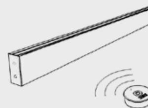
**Ricevitore wireless 2.4G incoporato nel profilo Funzione on/off e dimmerazione. Accessori obbligatori: radio comandi RU4, R1-1 o T16 touch panel in vetro. Wireless 2.4G receiver integrated into the profile. Required accessory: RU4 or R1-1 radio remote control or T16 glass touch panel.**
