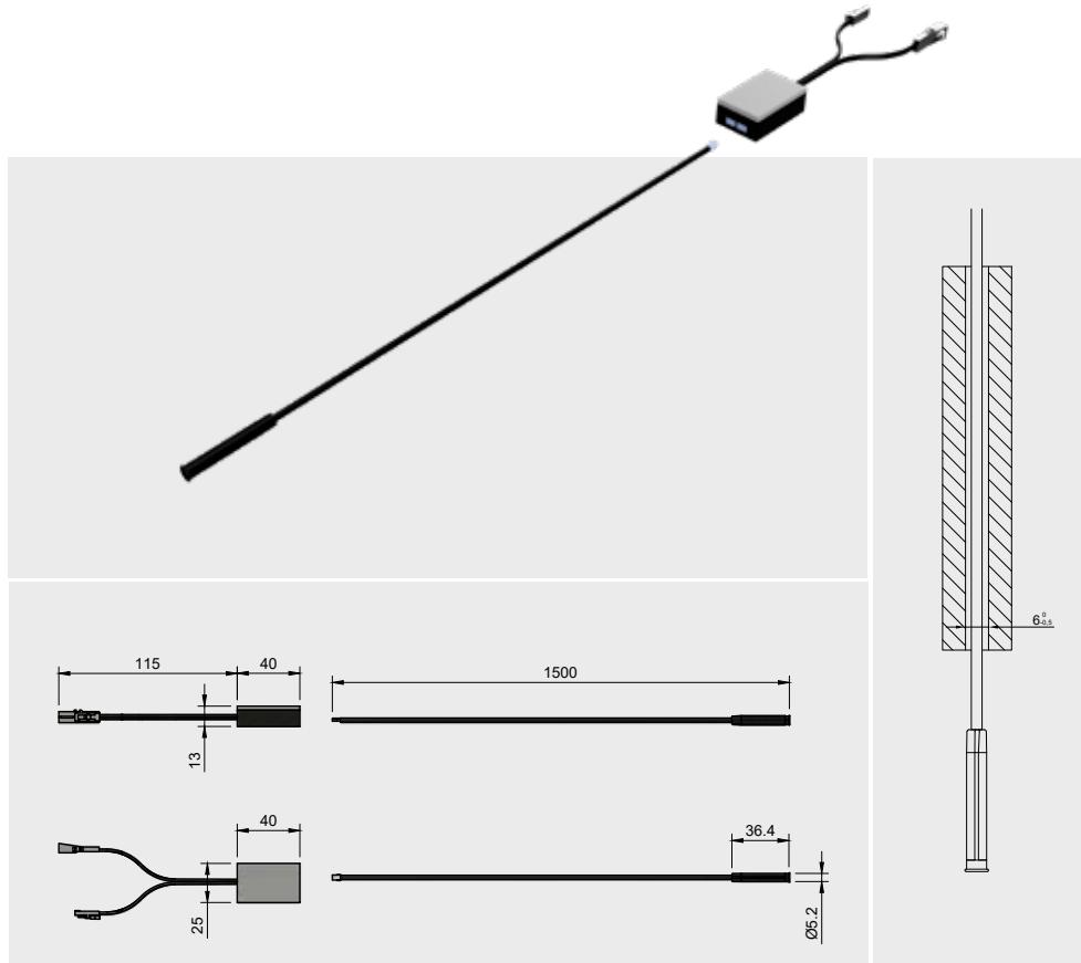
**Innovativo micro sensore elettronico di controllo degli apparecchi di illuminazione a LED per installazione ad incasso su fori d. 6mm, che si collega tra l'alimentatore e le lampade. Programmato in modalità fine-corsa, MIR accende e spegne gli apparecchi in modalità soft on/off con l'apertura e la chiusura dell'anta sul retro della quale è stato installato.**
