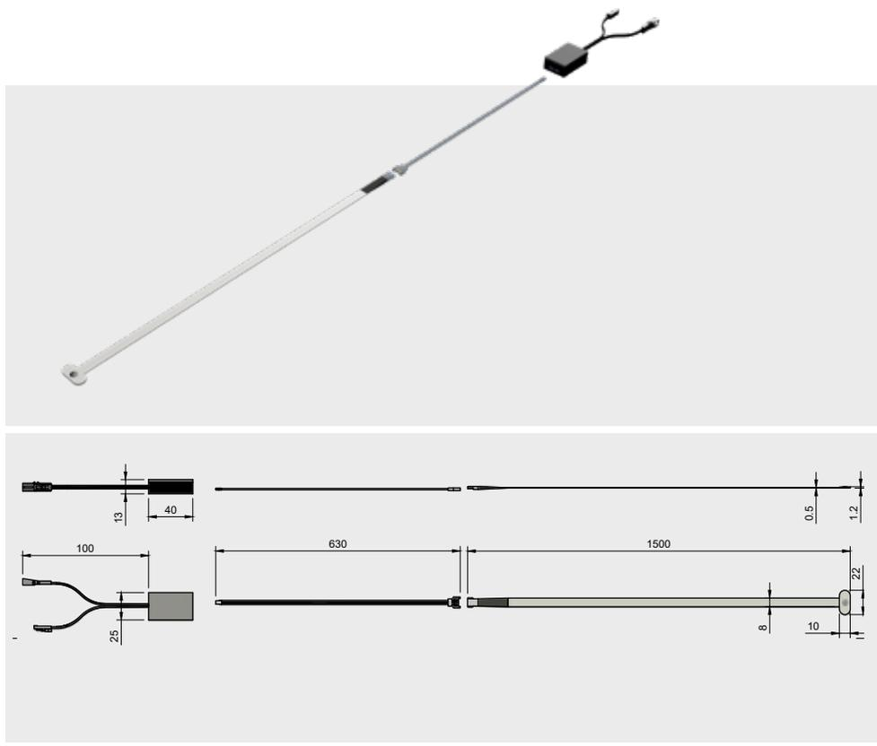
È un sensore singolo con tecnologia a membrana sottilissimo che viene attivato con una pressione sulla testa.
