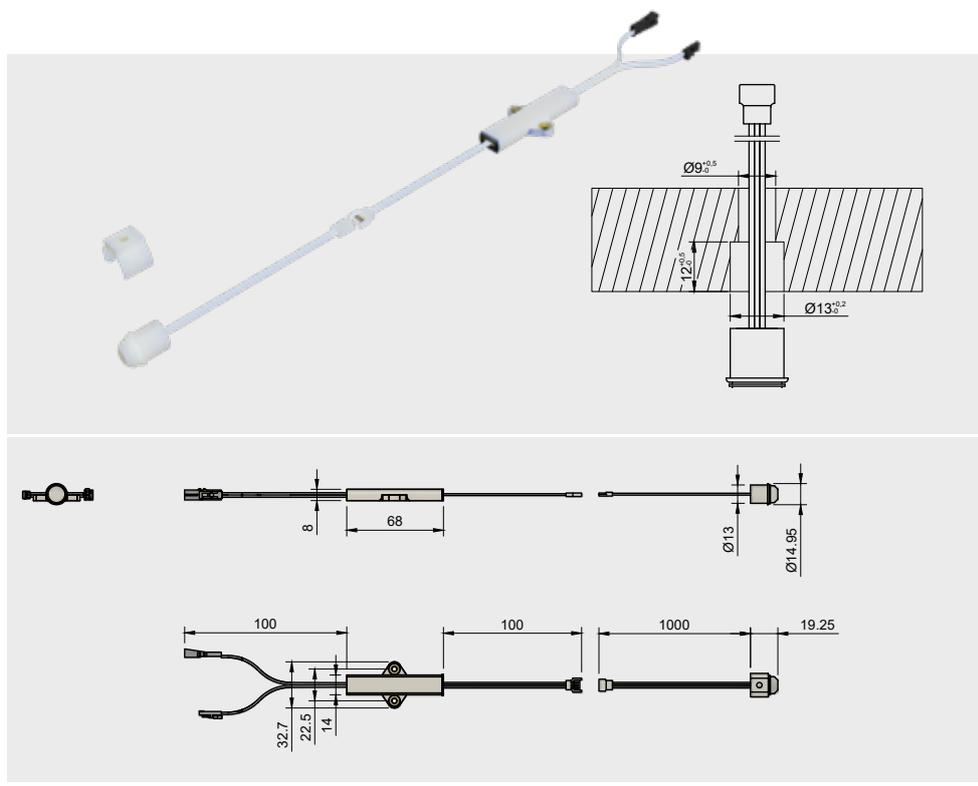
**Sensore di movimento singolo. Sensore elettronico di rilevamento del movimento di persone all'interno del raggio di azione, per montaggio ad incasso o per montaggio sporgente con clips in dotazione. Il sensore SPS è dotato di timer e l'accensione e lo spegnimento dell'apparecchio avviene attraverso il sensore di presenza. Il sistema rimane in funzione e se non rileva altri movimenti, si spegne automaticamente.**
