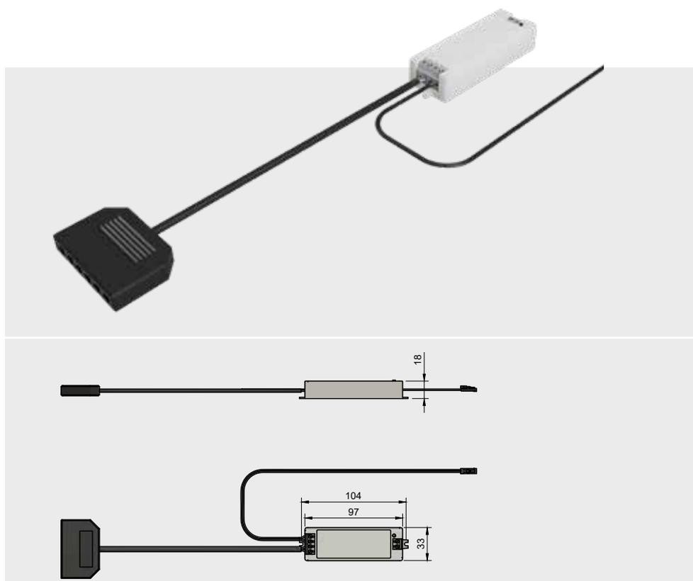
**Ricevente wireless RF 2.4Gz multitemensione. ZV1 è una centralina ricevente wireless dimmerabile che può essere pilotata a distanza con radiocomando mono o multi canale. Consente di accendere, spegnere, regolare l'intensità luminosa degli apparecchi a luce statica. Ogni centralina è cablata con un cavo di alimentazione e un distributore a 6-vie (LV).**
